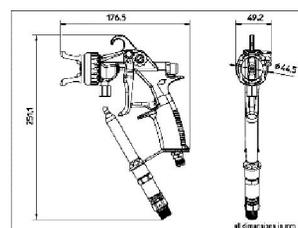
***Pistola a media pressione con atomizzazione airless ed aria supplementare per la regolazione del ventaglio e l'uniformità della spruzzatura. Pratica, maneggevole, morbida nella distensione del prodotto. Ideale l'utilizzo con pressioni da 80 a 150 bar.***
